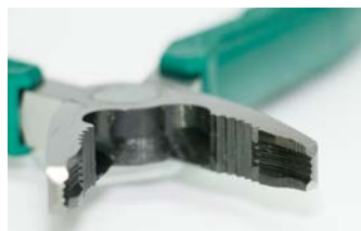
先端の縦ミゾに注目。錆びたり頭がつぶれたネジでも外せる発明だ。
